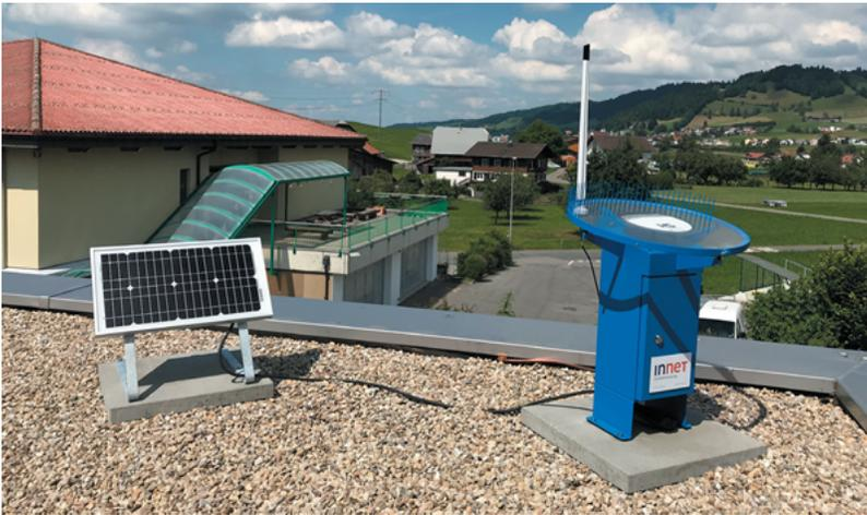
Figura 1: Sensore della grandine automatico con pannello fotovoltaico
