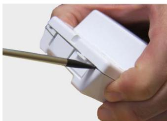
Vogliate aprire il coperchio con un cacciavite nei due punti indicati all'estremità della radiosonda.
